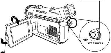
Presione el botón de apertura del LCD (LCD-OPEN) para destrabar el monitor LCD. Gírela hasta abrir completamente y ajusta el ángulo.
